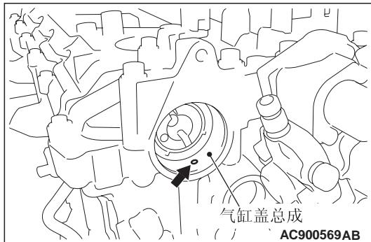
检查确认真空泵安装孔的内侧面没有异物，如密封剂。安装真空泵总成。
